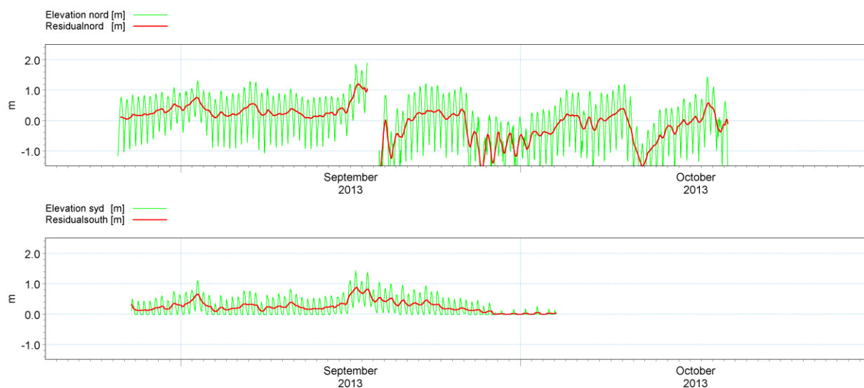
Figur 5-1 Vandstandsmålinger i begge ender af Lundby Løb.
